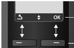
Aktuelle Funktionen der Display-Tasten werden in der untersten Displayzeile angezeigt.
